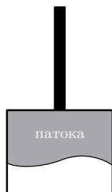
Рис. 8.5: Тряска удерживает патоку от перетекания вниз.
