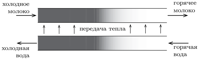
Рис. 10.2: Противоточный теплообменник обеспечивает почти полный обмен температурами.
